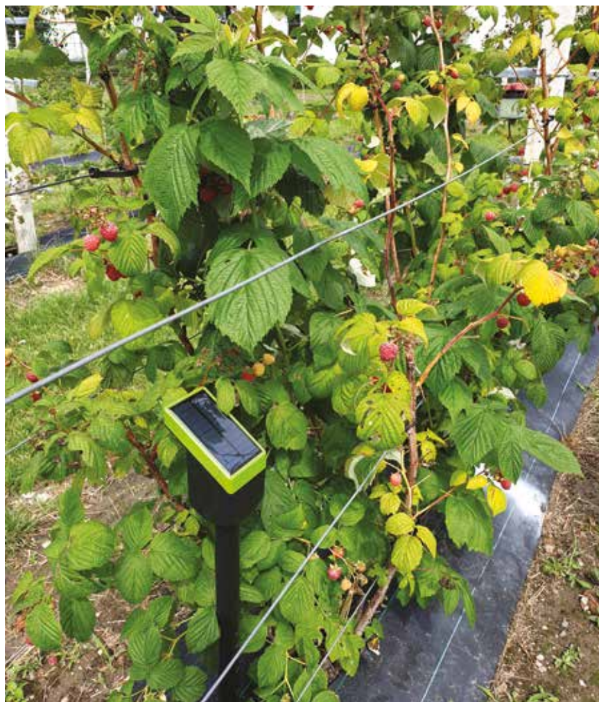
Sonda glebowa systemu AGREUS® w uprawie maliny
