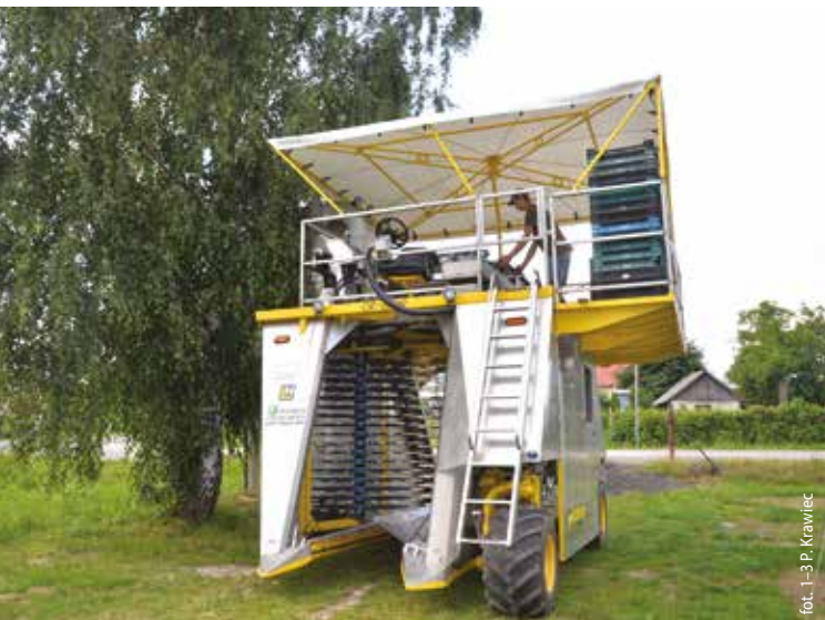
Fot. 1. Samobieżny kombajn Littau Harvester do zbioru malin
